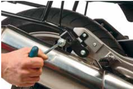
1. Untere Lock-it Schraube lösen
