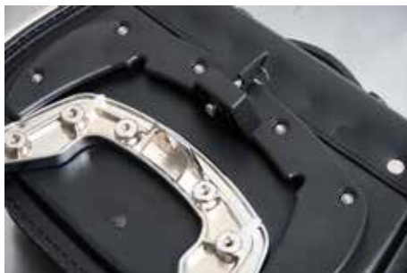
Einfache Anbringung der Seitentaschen am C-Bow mit Schlosssicherung
