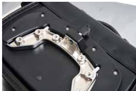
Einfache Anbringung der Seitentaschen am C-Bow mit Schlosssicherung
