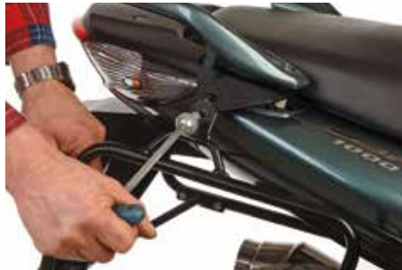
2. Obere Lock-it Schraube lösen
