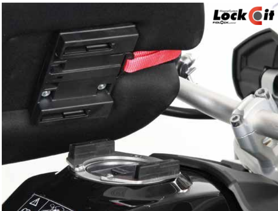
Unterseite eines Tankrucksacks mit passendem Gegenstück zum Tankring
