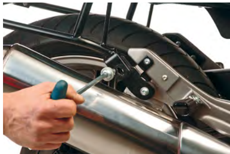
1. Dévisser la vis Lock-it inférieure
