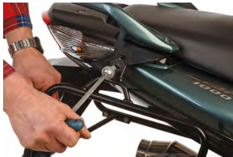
2. Dévisser la vis Lock-it supérieure
