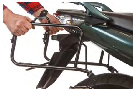
3. rimuovere completamente il supporto
