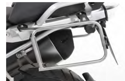
Portabagagli in acciaio inox fissato tramite viti
