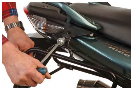
2. allentare la vite Lock-it superiore
