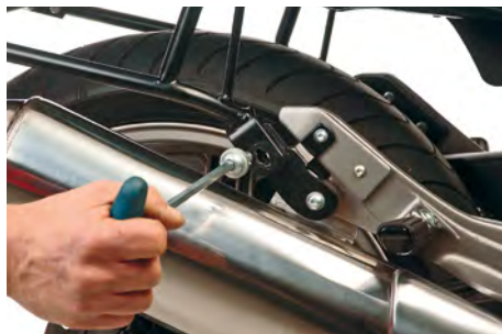
1. allentare la vite Lock-it inferiore
